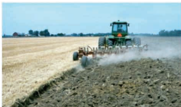
شکل ۴-۶. انجام شخم با استفاده از گاواهن برگردان‌دار در رطوبت مناسب خاک
