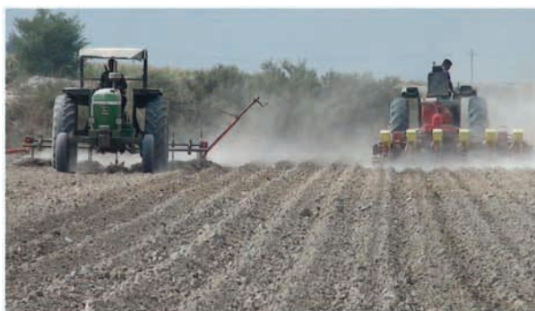
شکل ۵-۱. ایجاد جوی و پشته مزرعه چغندر قند بوسیله دستگاه فاروئر مجهز به مارکر و استفاده از بذرکار پنوماتیک جهت کاشت بذر در خوزستان
