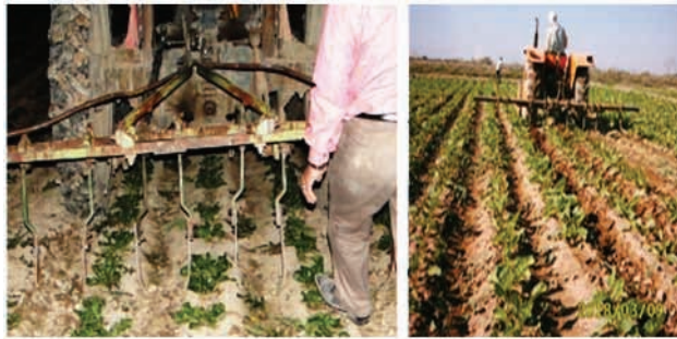
شکل ۹-۷. کنترل مکانیکی علف‌های هرز با استفاده از کولتیواتور شمشیری (راست) و U شکل (چپ)
